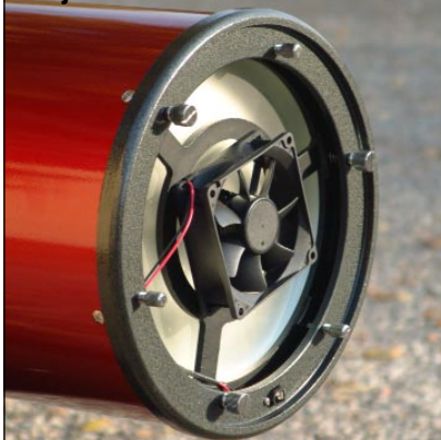
D8 Spiegelzelle mit Lüfter und Justierschrauben
