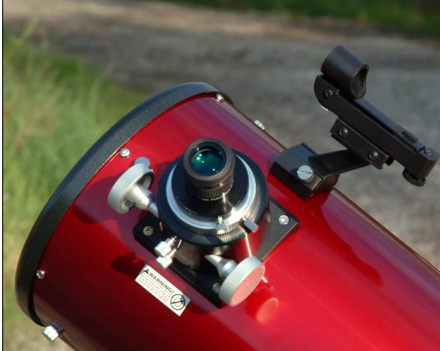
D8-K-CR mit Lichtpunktsucher, 2" Crayford und 32 mm Plössl
